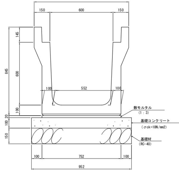
PU型側溝 グレーチング蓋 600×600 S=1:40
