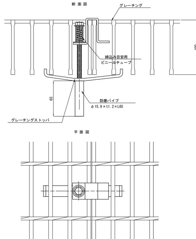
グレーチング蓋固定金具 可変側溝400×400~600 既設自由勾配側溝400×300 S=1:8
