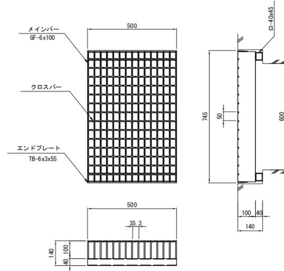
グレーチング蓋 可変側溝400×400~600 既設自由勾配側溝400×300 S=1:40
