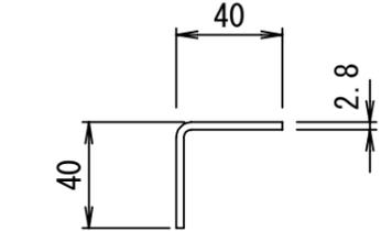
端柱断面図 S=1/3
